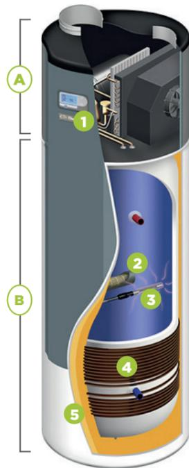
Comme une pompe à chaleur aérothermique, un chauffe-eau thermodynamique utilise les calories présentes dans l'air afin de chauffer un liquide caloporteur. Ce fluide restitue ensuite la chaleur au ballon pour produire de l'eau chaude.
